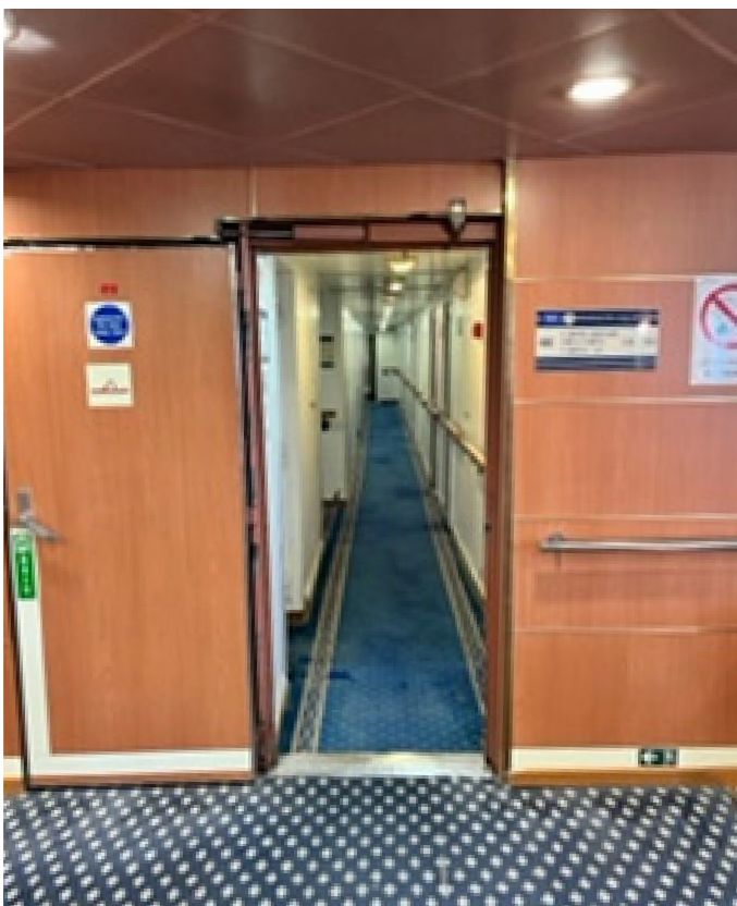
9. INGRESSO AREA CABINE PMR PONTE 7: Larghezza 80cm
